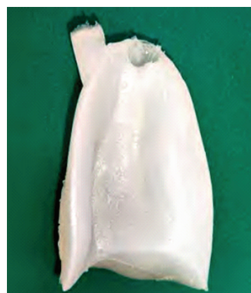
图 7 单气腔仿肺变形软体机器人
