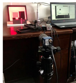
图5 平面度测量实验现场
