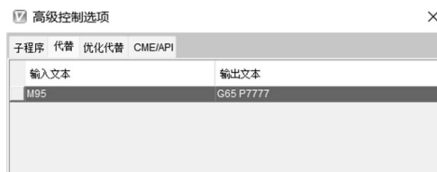
图 12 更换主轴头指令替换配置示意图
