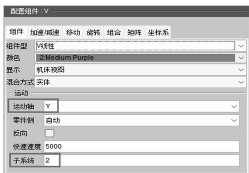
图 10 V 轴(虚拟轴)组件配置示意图
